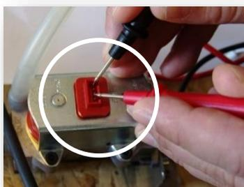
Brennerautomat defekt. Tauschen Sie den Brennerautomat aus
