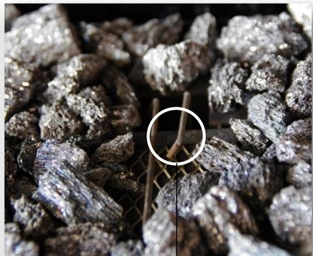
Die Zündelektrode ist auf dem Brenner mit dem Symbol V gekennzeichnet. Kontrollieren Sie den Abstand der Zündelektrode (5-7 mm). Stellen Sie sicher, dass keine Funken zwischen Zündelektrode und Verkabelung entstehen. Ist das der Fall?
