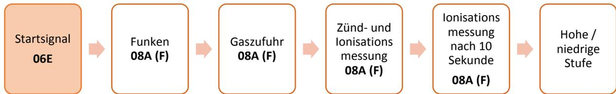
Auf der Fernbedienung ist eine blinkende Antenne oder 06E zu sehen. Das bedeutet, dass der Brennerautomat (in der Technikbox) keine Verbindung zur Fernbedienung herstellen kann.
