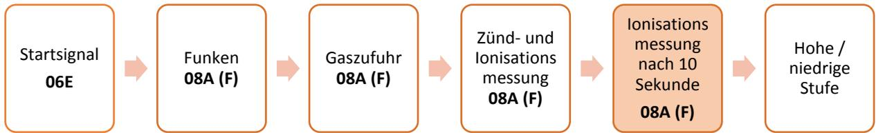
Sie drücken die Einschalttaste (Befeuern). Die Feuerstelle zündet und brennt, schaltet aber zwischen 5 Sekunden und maximal 8 Stunden nach der Zündung auf Störung. Die Fehlermeldung 08A(F) erscheint (fehlende Ionisation). Was kann die Ursache dafür sein?
