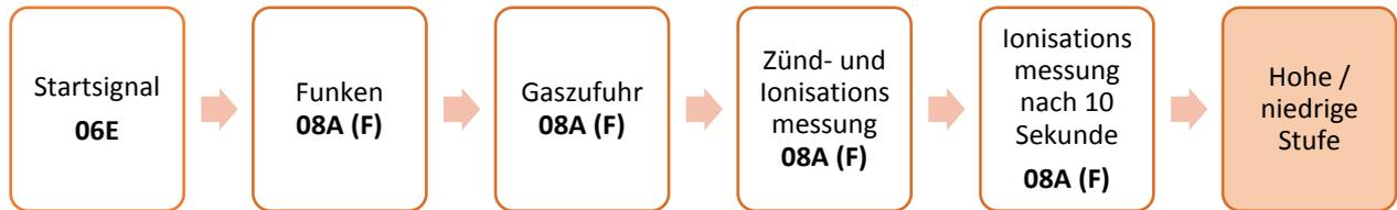
Sie drücken die Einschalttaste (Befeuern). Die Feuerstelle zündet und brennt. Was kann die Ursache der Probleme sein, die bei hoher/niedriger Betriebsstufe auftreten?
